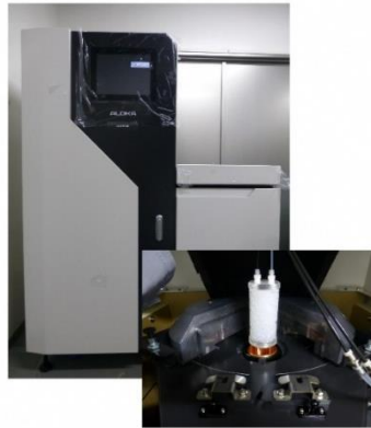
開発したトリチウムモニターの概観図
