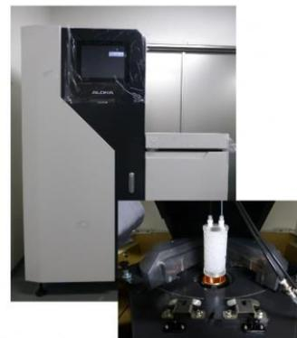
開発したトリチウムモニターの概観
