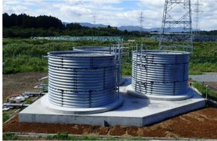
3種の溶融飛灰を用いた屋外実証試験の様子（JESCO撮影）
