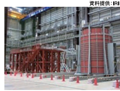
PCV内部調査用モックアップ試験設備 (実物大試験設備)
