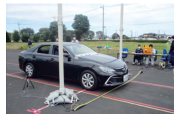
可搬型ゲート型モニタを使用した測定実験
